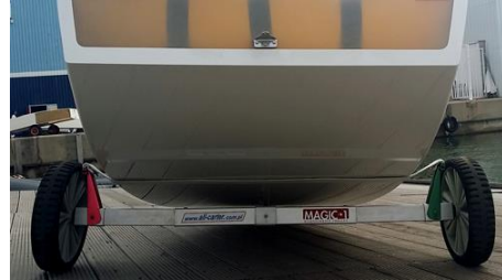
Carrito plegable en funda con ruedas rígidas y correcta tensión de cincha.
